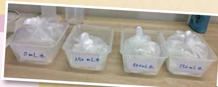
▲ 水袋重量的實驗設置
